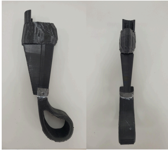
Figura 1 - Prótese canina de membro inferior feita em impressão 3D
