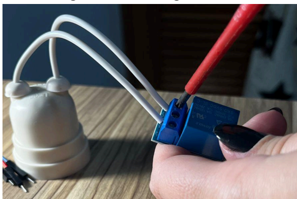
Figura 25 - Montagem do relé
