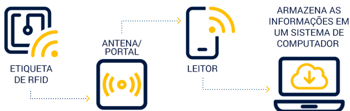
Figura 2 - Funcionamento da tecnologia RFID
