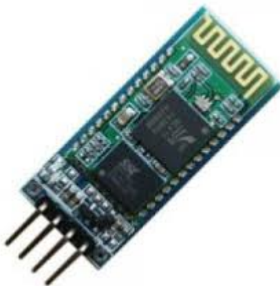
Figura 8 - Módulo bluetooth HC-06 Fonte: Vida de Silício (2025)
