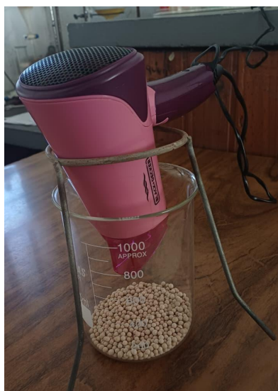
Figura 71 - Processo de dessorção
