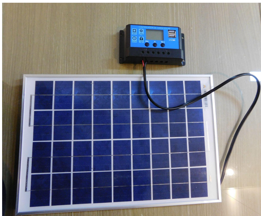
Figura 51 - Ligação do módulo fotovoltaico
