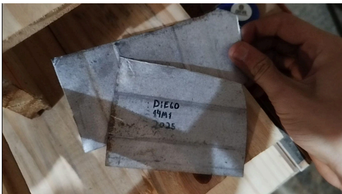
Figura 24 - Chapas de aço zincado para teste de soldagem
