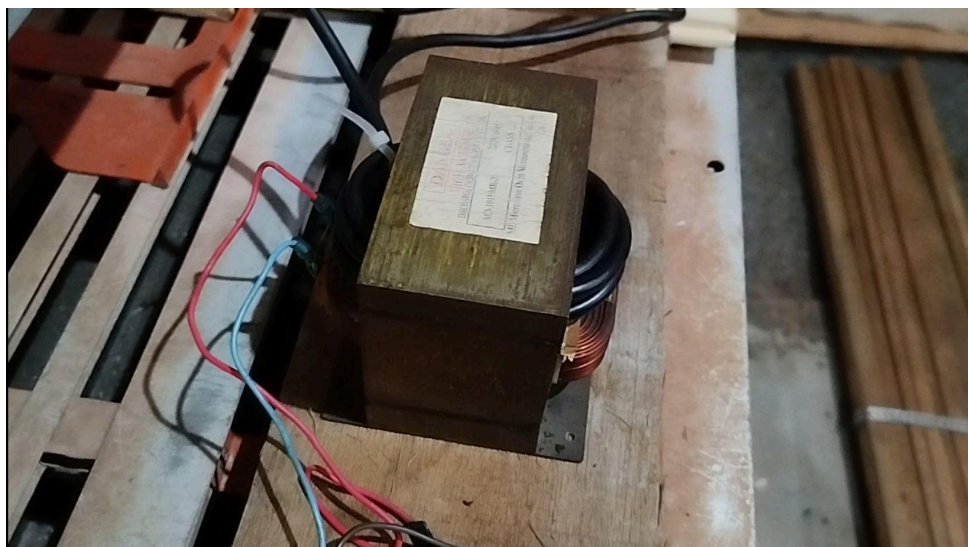
Figura 22 - Transformador de forno de micro-ondas
