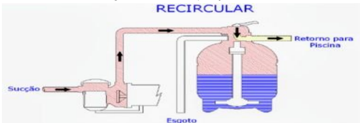
Figura 8 - Fluxo de operação de recircular
