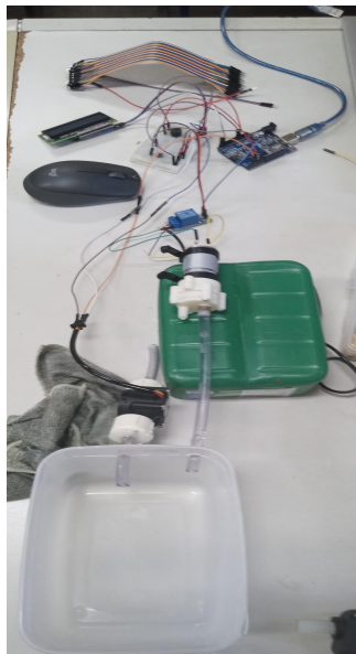
Figura 40 - Antigo sistema eletrônico de supervisão direta do dreno
