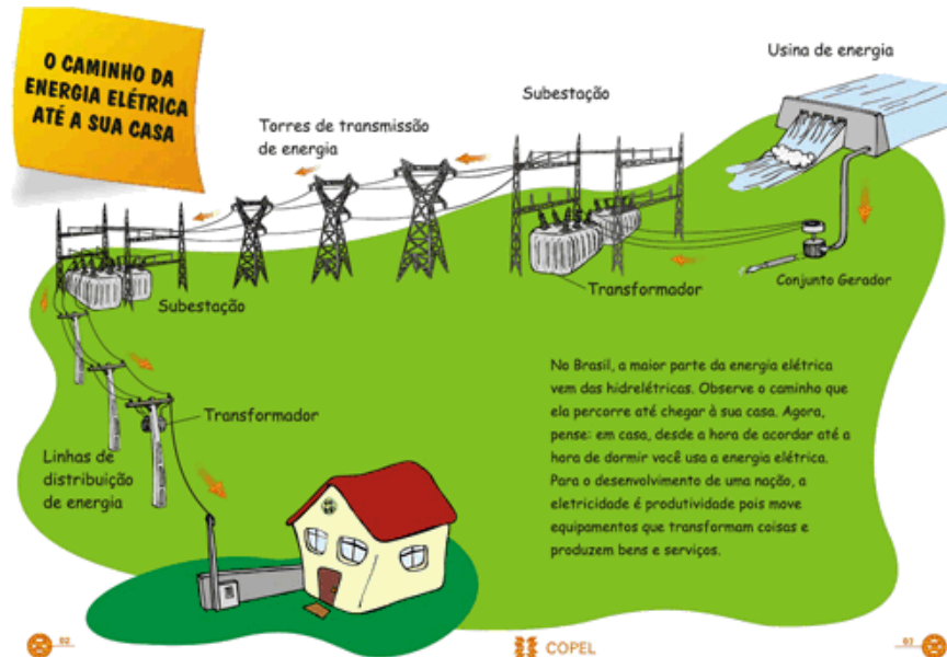
Figura 1 - Distribuição de energia
