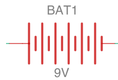
Figura 15 - Bateria 9V esquema elétrico
